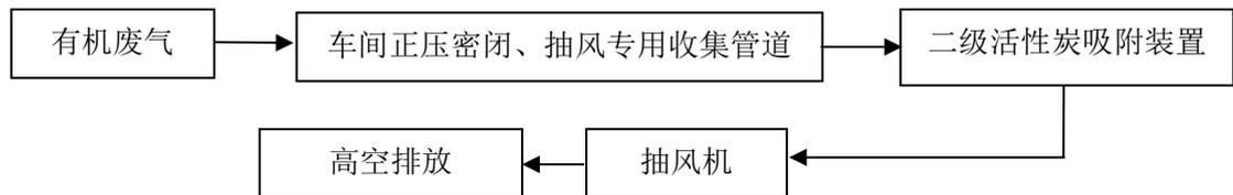
**活性炭吸附原理：**吸附现象是发生在两个不同的相界面的现象，吸附过程就是在界面上的扩散过程，是发生在固体表面的吸附，这是由于固体表面存在着剩余的吸引而引起的。吸附可分为物理吸附和化学吸附；物理吸附亦称范德华吸附，是由于吸附剂与吸附质分子之间的静电力或范德华引力导致物理吸附引起的，当固体和气体之间的分子引力大于气体分子之间的引力时，即使气体的压力低于与操作温度相对应和饱和蒸气压，气体分子也会冷凝在固体表面上，物理吸附是一种吸热过程。化学吸附亦称活性吸附，是由于吸附剂表面与吸附质分子间的化学反应力导致化学吸附，它涉及分子中化学键的破坏和重新结合，因此，化学吸附过程的吸附热较物理吸附过程大。在吸附过程中，物理吸附和化学吸附之间没有严格的界限，同一物质在较低温度下往往是化学吸附。活性炭纤维吸附以物理吸附为主，但由于表面活性剂的存在，也有一定的化学吸附作用。
